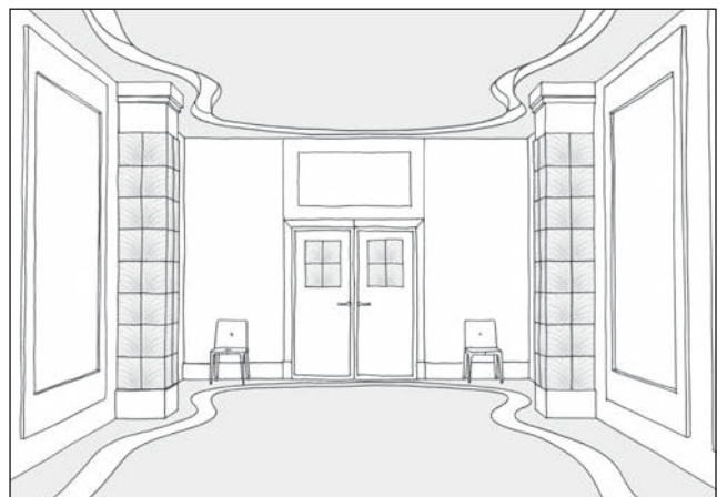
Ensembles de panneaux Coutard insérés sur des colonnes Set of Coutard panels integrated in pillars
